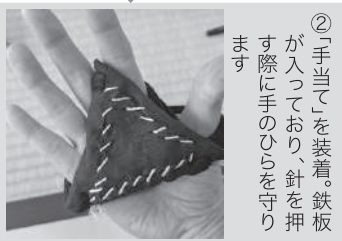
②「手当て」を装着。鉄板が入っており、針を押しやす手に手のひらを守ります
